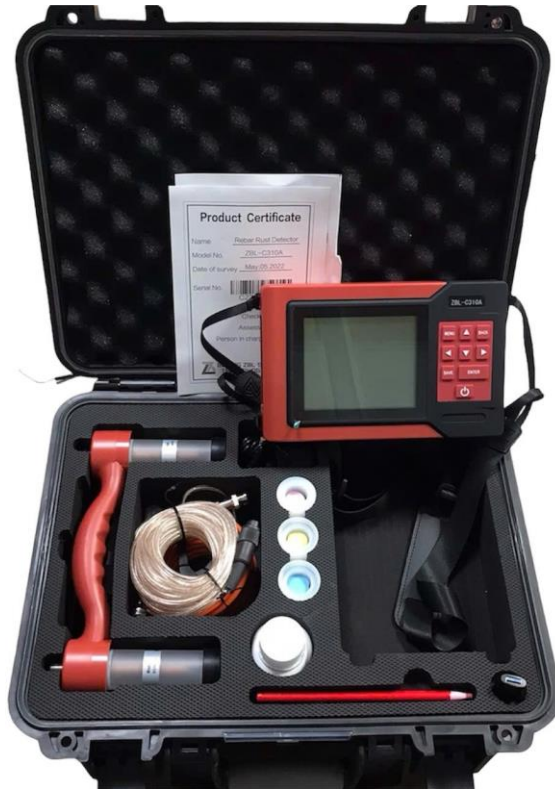
Máy đo ăn mòn cốt thép trong bê tông/ Corrosion gauge for reinforcement in concrete
