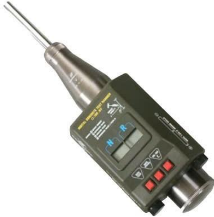
SÚNG BẬT NẤY/ REBOUND HAMMER
